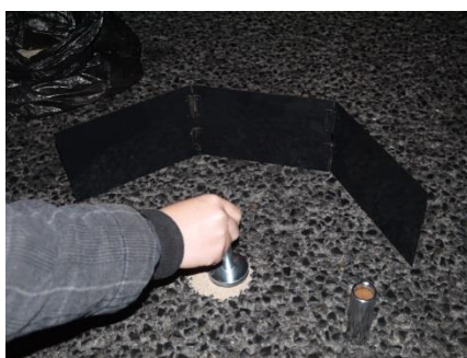
图 3.7 手工铺砂法测量构造深度
