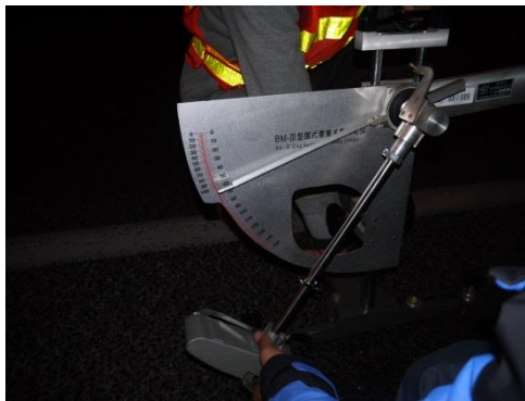
图 3.8 摆式仪测路面抗滑值
