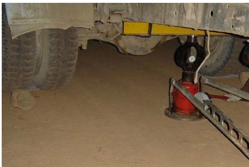
图 3.3 承载板检测土基静态模量
