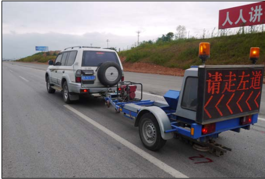
图 2.9 FWD 现场检测弯沉
